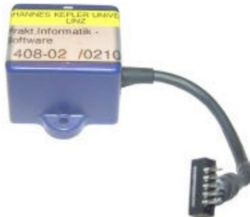
Abbildung 26: InertiaCube<sup>2</sup> mit gekürzten Kabel und neuem Stecker
